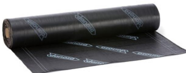
Lámina impermeabilizante bituminosa de superficie no protegida tipo LBM(SBS)-40-FP. Compuesta por una armadura de fieltro de poliéster no tejido, recubierta por ambas caras con un mástico de betún modificado con elastómeros (SBS), usando como material antiadherente un film plástico por ambas caras.
